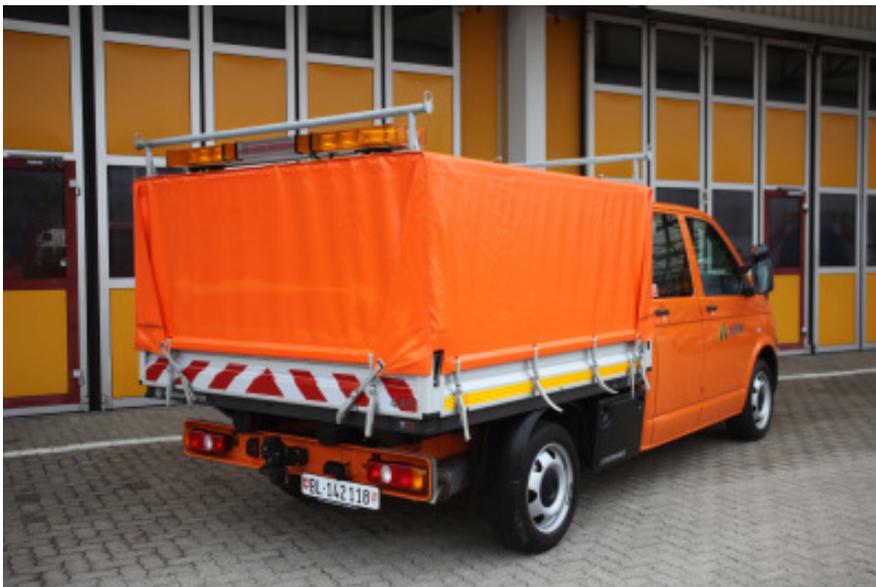
**Bild 6:** Auf der Werksbrücke baute die Firma Rolf Waldspurger AG ein Blachenverdeck auf und auch zwischen Chassis und Aufbau wurden noch Leerräume genutzt.
