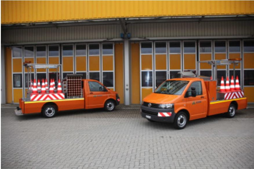
**Bild 7:** Dank einem Gesamtgewicht von 3'500 kg können die drei neuen Signal-Fahrzeuge viel Sicherungsmaterial mitnehmen.
