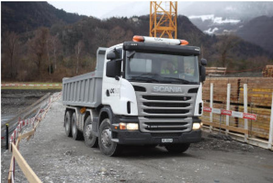
Ob mit Drehmischer oder als Kipper, dank Wechselsystem lassen sich die unterschiedlichen Aufbauten schnell und effizient wechseln.
