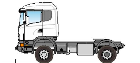
Diese allradangetriebene Sattelzugmaschine ist direkt ab Werk einsatzbereit, einschließlich Sattelkupplung, Nebenantrieb und Hydrauliksystem: Auflieger aufsatteln und losfahren. Vorder- und Hinterachsen haben eine Achslast von 7,5 bzw. 11,5 Tonnen und sind mit Trommelbremsen bestückt. Als Fahrerhaus kommt ein mittelhohes langes Fahrerhaus der G-Serie von Scania zum Einsatz. Zur Ausstattung gehören auch Parabelfedern vorne sowie Luftfederung hinten.
