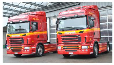
Die beiden Euro-6-Sattelzugmaschinen ziehen im nationalen Verteilerverkehr je einen City-Trailer und einen 2-Achsauflieger.
