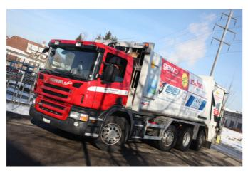
le nouveau véhicule dans le parc de véhicules de la Reusser Transporte AG est un Scania P400 LB 8x2\*/6. Grâce à un essieu de guidage et un essieu porteur relevable et dirigeable, le véhicule est plus manœuvrable que bien des véhicules à trois essieux, malgré l'illusion d'optique.
