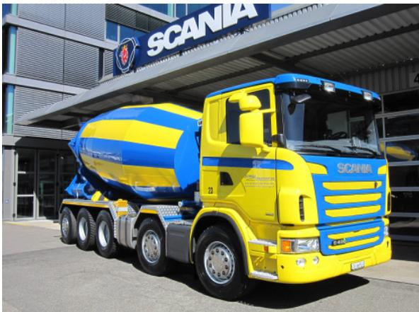
le premier camion Euro 6 dans le parc de véhicules de l'entreprise De Paola Transport AG à Aesch près de Birmensdorf est un Scania G480 LB 10x4\*6 HNA 41. les Scania à 5 essieux sont convaincants par un poids à vide extrêmement bas et, grâce à l'essieu porteur relevable et dirigeable, également par une manœuvrabilité élevée.
