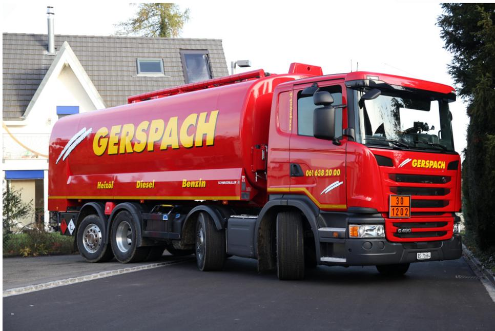
Un des trois nouveaux véhicules à citerne dans le parc roulant de la GERSPACH AG à Bâle. Grâce aux trois essieux dirigés, les nouveaux camions citernes sont encore plus agiles que les véhicules 6x2 utilisés jusqu'à présent.
